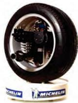
Ce sont les chercheurs du groupe Michelin, qui ont mis au point ce système de propulsion, révolutionnaire. Il s'agit d'un petit moteur électrique disposé dans chacune des roues de la voiture. Et le fait de loger les moteurs dans les
