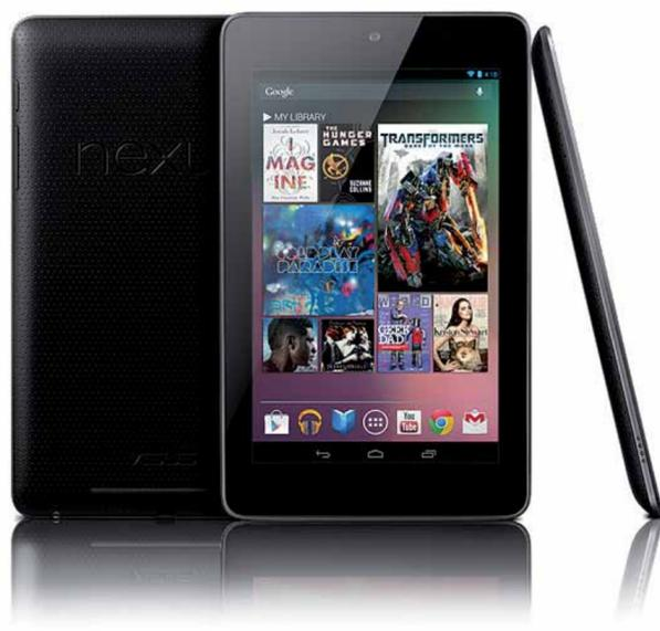
« Une véritable console de jeux » La tablette de Google dispose du Wi-Fi, du Bluetooth, d'un GPS et d'une puce NFC. Déclinée en versions 8 et 16 Go, elle intègre un port micro-USB, ainsi qu'un gyroscope et un magnétomètre, mais fait l'impasse sur l'extension du stockage par carte mémoire. « Nous voulions rassembler le meilleur de l'expérience Google, optimisé autour du contenu disponible sur Google Play », a indiqué Google, indiquant que le magasin en ligne compte désormais « plus de 600 000
